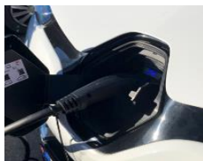
Renault ZOE. Stik udløses på knap til venstre for rattet
